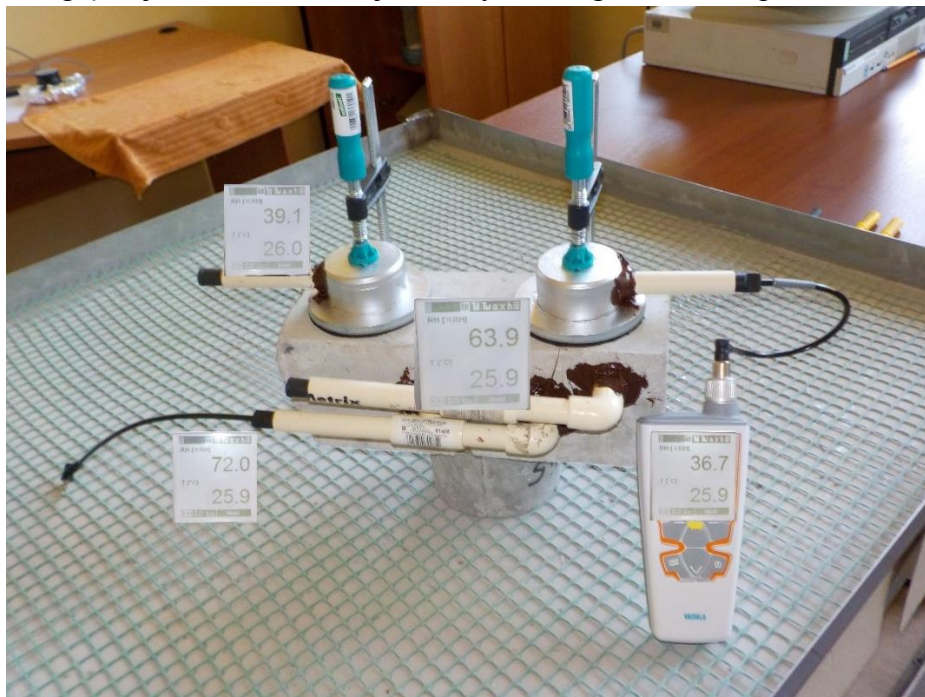
Rys. 1. Pomiar wilgotności powierzchniowej betonu
